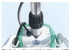
● サポートングロッド/スプリングダンパーの調整で上下高さ設定が手軽にできます。
